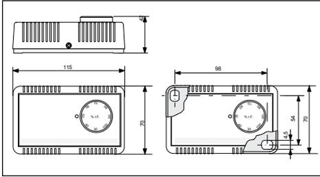
**⚠ Das Gerät darf nicht mit Spannungen über 48 V betrieben werden! Bei hoher Spannung besteht die Gefahr, daß bei einem Wasserniederschlag auf dem Mikroschalter oder auf den Anschlußklemmen Spannungsüberschläge erfolgen können und somit den Regler zerstören. Bei Spannungen unterhalb 48 V kann der Feuchteregler bis 100 % r.F. eingesetzt werden**
